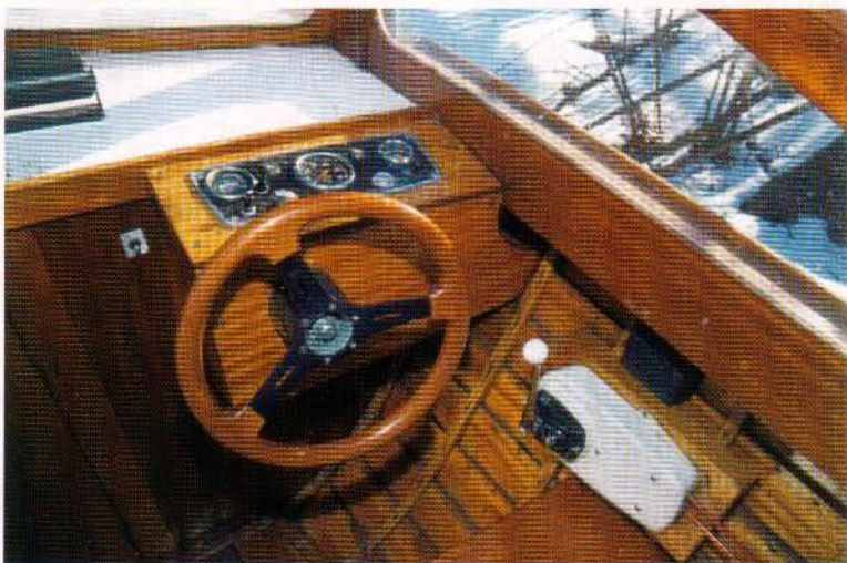
Ratten är utbytt mot en modernare variant, instrumentpanelen original Volvo Penta. Idealet är att först besiktiga båten på land, därefter i sjön så motor, mätare, styrning och reglage kan kontrolleras.
