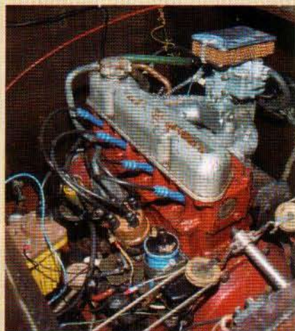
B18 med AQ 100-drev är aldrig fel. Ägaren Stefan hade haft problem med Stromberg originalförgasaren och monterat en Weber. Bränsleledningen var dåligt klamrad, batteriet stod löst på ena sidan men bör vara placerat utanför motorrummet och stå i en syrabeständig plastlåda som är ventilerad till utsidan av båten.
