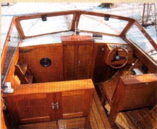
Ruffdörrarna har svällt och går inte att stänga. Men de är lätta att hyvla av en bit.
